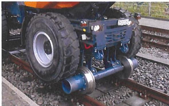
3 caméras intégrées dans la commande, 1 à l'avant et 1 à l'arrière pour mettre sur rail et 1 pour la vue vers l'avant en mode route. Verrouillage des amortisseurs à lames des deux côtés sur l'essieu arrière. Y compris homologation CFF
