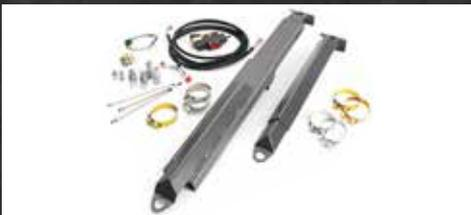
Präzise proportional steuerbare Extra-Hydraulikfunktion, z. B. Drehfunktion eines Sortiergreifers oder einer Stahlschere. Dieses Paket enthält ebenfalls Hydraulikzylinderschutze für die Zylinder C2 und C3 als Anprall- und Hitzeschutz. Verfügbar für alle DXR-Modelle.
